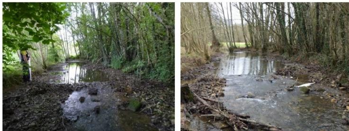
Vues du radier LAM_RAD_1, en amont immédiat de la station Estimhab, long d'environ 3 m, à Q1 (0,019 m³/s) à gauche, et à Q2 (0,103 m³/s) à droite
